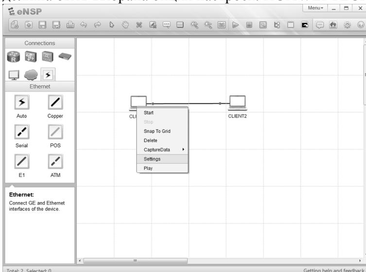
Опция настроек в окне свойств отображает набор из четырех вкладок для настройки базовой конфигурации, интерфейса командной строки устройства, конфигурации генератора многоадресного трафика и конфигурации генератора пакетов UDP.
