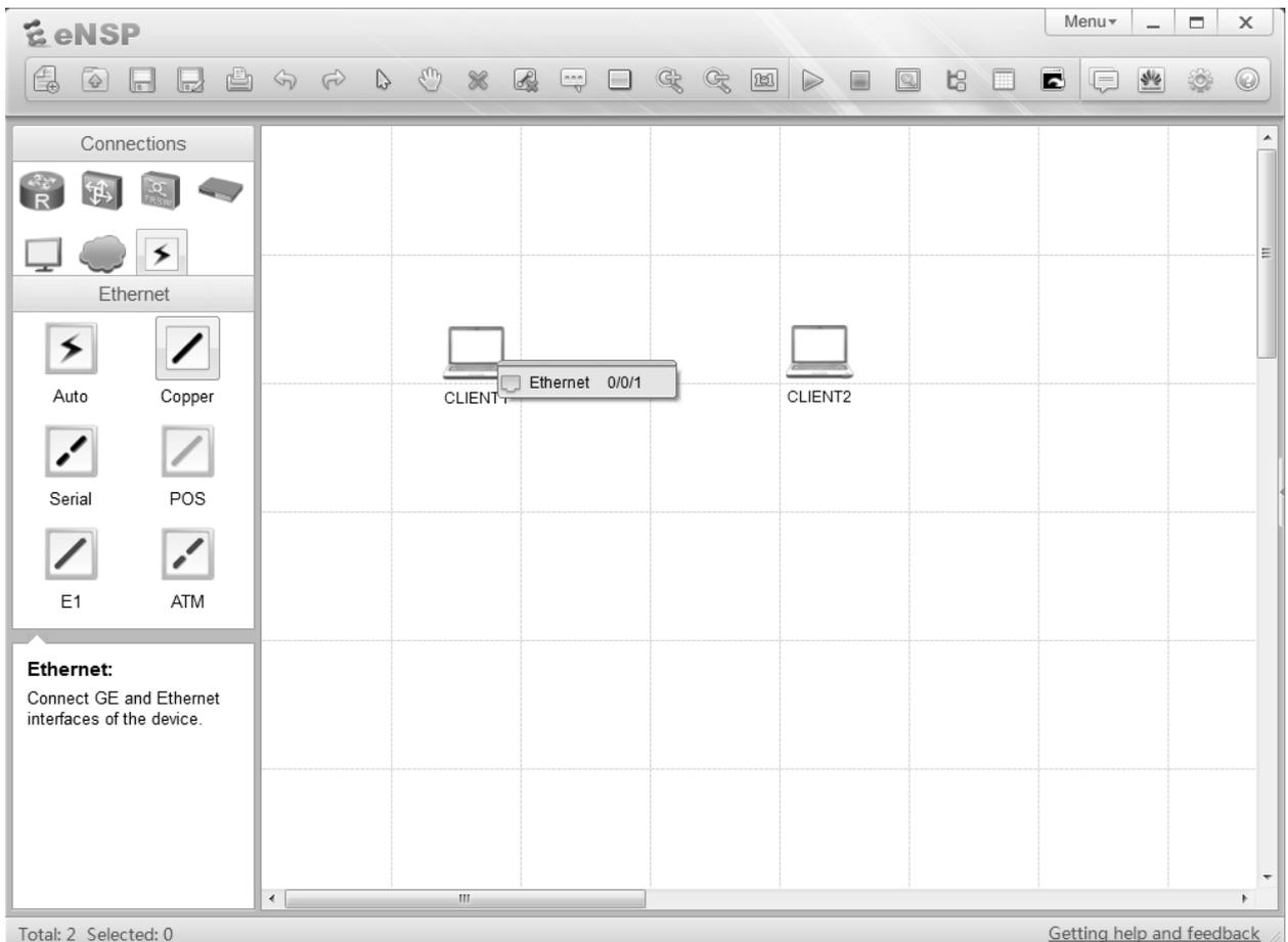
Как только это будет достигнуто, нажмите на взаимодействующее устройство, чтобы применить противоположную сторону среды к конечной системе. Снова выберите интерфейс Ethernet 0/0/1, чтобы установить среду между двумя устройствами и завершить построение одноранговой топологии.
