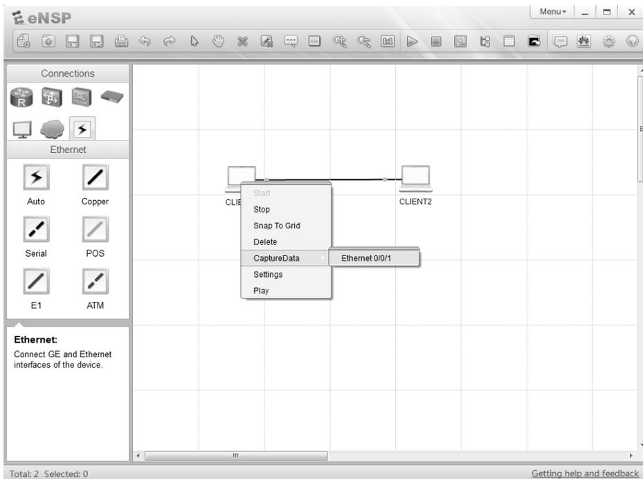
Выбор интерфейса приведет к активации инструмента захвата пакетов Wireshark для выбранного интерфейса. Если необходимо отслеживать дополнительные интерфейсы, будут активированы отдельные экземпляры одного и того же инструмента захвата пакетов.
