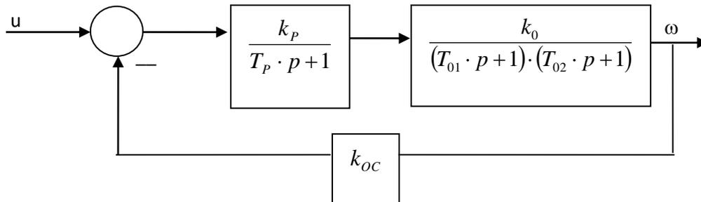
Рис. 1. Исходная структурная схема системы регулирования частоты вращения ротора двигателя ( $k_p$  – передаточный коэффициент;  $T_p$  – постоянная времени, с;  $k_0$  – передаточный коэффициент двигателя (объекта) по каналу управления;  $T_{01}$  и  $T_{02}$  – постоянные времени двигателя, с;  $k_{0c}$  – передаточный коэффициент обратной связи)
