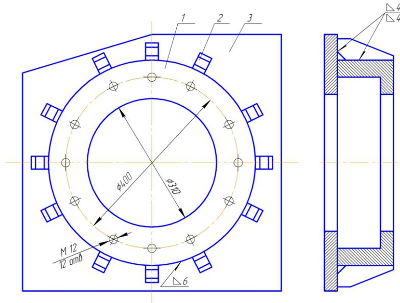
Кожух бортового фрикциона. Программа 20 000 шт. в год.
