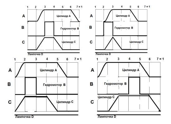
**Задание 2.** Согласно заданной диаграммы перемещения разработать системы управления: 1 - используя релейно-контактные схемы; 2 - используя (симулятор) контроллера в программе FluidSim-H.
