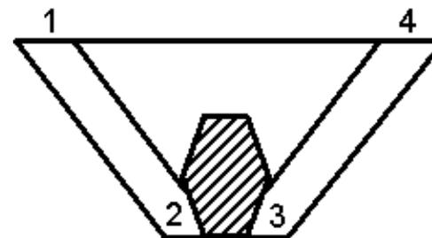
а)  $K_{конт} = \frac{V_{1-2} + V_{2-3} + V_{3-4}}{V_{2-3}};$       б)  $K_{конт} = \frac{V_{2-3}}{V_{1-2} + V_{3-4}};$
