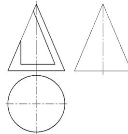
2. Применяя графический редактор построить линии пересечения поверхностей. Записать характерные точки. Показать выносной элемент.
