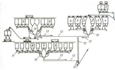
Рис. 6. Схема шихтоподдачи доменной печи "Алпанда" объемом 2032 м<sup>3</sup>.
