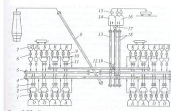
Рис. 5.70. Схема конвейерной шихтоподдачи доменной печи объемом 5000 м<sup>3</sup>.
