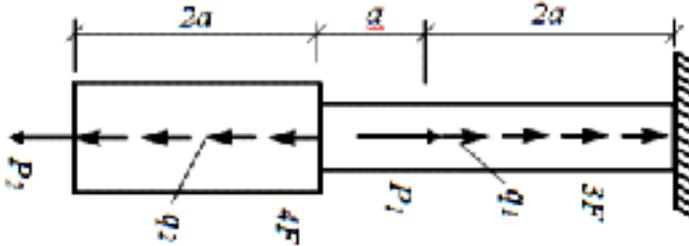
*Задача 2.* Построить эпюру крутящих моментов углов закручивания; найти наибольший относительный угол закручивания.
