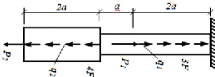
*Задача 2.* Построить эпюру крутящих моментов углов закручивания; найти наибольший относительный угол закручивания.
