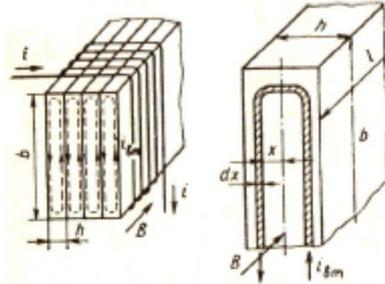
Большие стороны этих контуров отстоят от вертикальной оси сечения листа соответственно на  $x$  и  $x+dx$ . Так как  $h \ll b$ , то можно считать, что длина большой стороны контура вихревого тока равна толщине листа  $b$ . Тогда магнитный поток, пронизывающий полость цилиндра
