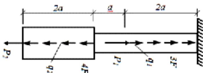
Задача 2. Построить эпюру крутящих моментов углов закручивания;
