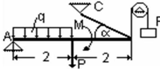
Определить реакцию опоры A и усилие в стержне BC.
