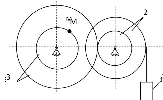
Колесо 3 с радиусами  $R_3 = 30$  см и  $r_3 = 10$  см и колесо 2 с радиусами  $R_2 = 20$  см и  $r_2 = 10$  см находятся в зацеплении. На тело 2 намотана, нить с грузом 1 на конце, который движется по закону  $s_1 = 4 + 90t^2$ , см. Определить  $v_M$ ,  $a_M$  в момент времени  $t_1 = 1$  с.
