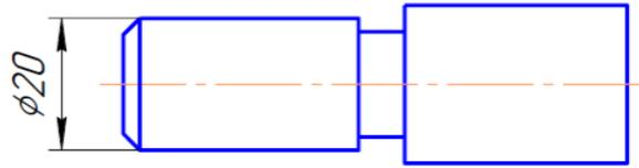
2. По данному чертежу рассчитать длину шпильки и дать ее условное обозначение (ГОСТ 22034-76, класс прочности 58).
