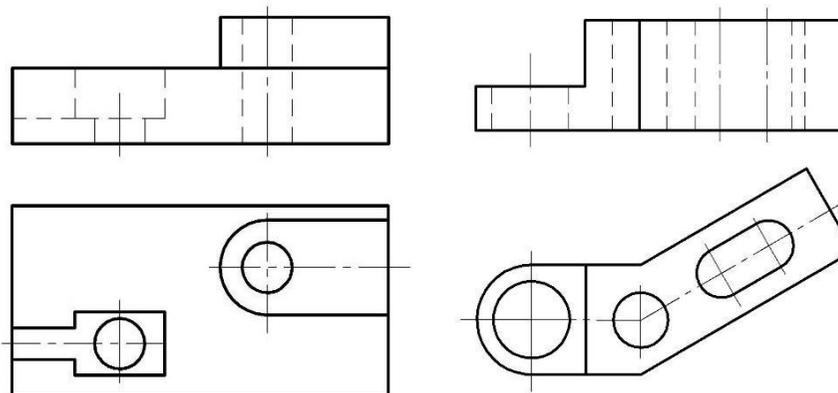
4. Построить вид слева, прямоугольную изометрию детали
