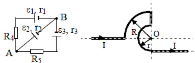
**Задача 11.** Бесконечно длинный проводник изогнут так, как это изображено на рисунке. Определить магнитную индукцию  $B$  поля, создаваемого в точке  $O$  током  $I = 80$  А, текущим по проводнику. Принять  $r = R/2$ , где  $R=1$  м.
