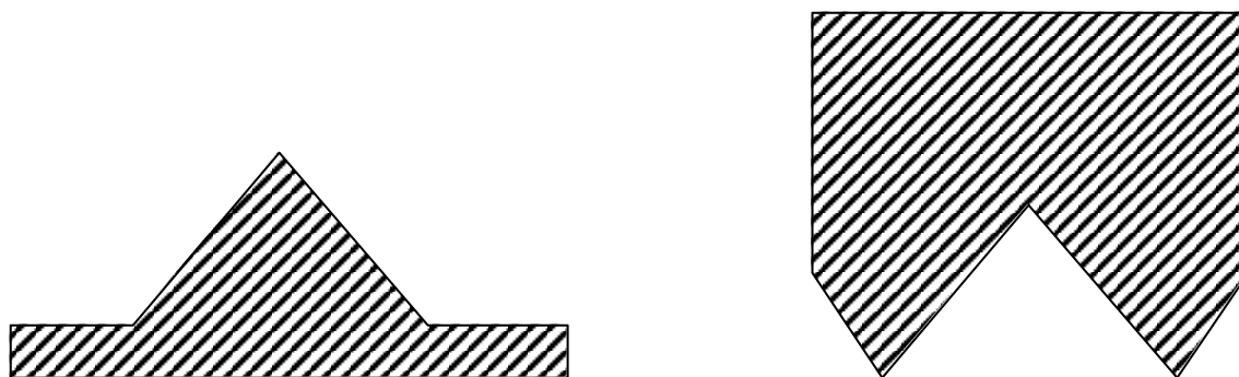
Рис. 4. Шаблоны для верхнего и нижнего ручьев угловой стали.
