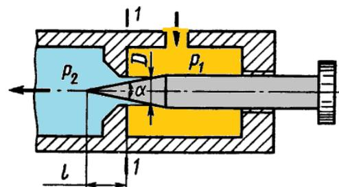
Указание. Площадь дросселирующего кольца определить по приближенной формуле  $S = S_0 - S_H$ , где  $S_0$ —площадь отверстия,  $S_H$  — площадь иглы в сечении 1—1.
