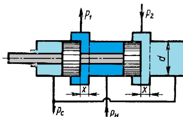
л/мин, если диаметры  $D = 20$  мм,  $d = 3$  мм; коэффициенты расхода дросселирующих отверстий  $\mu = 0,8$ , плотность рабочей жидкости  $\rho = 900$  кг/м<sup>3</sup>. Считать, что в пределах рабочего хода плунжера сила пружины остается-постоянной.
