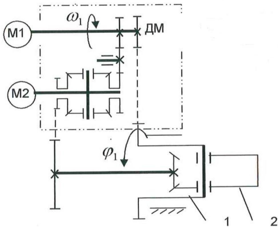
От двигателя M1 к звену 1, при функционирующем двигателе M2
