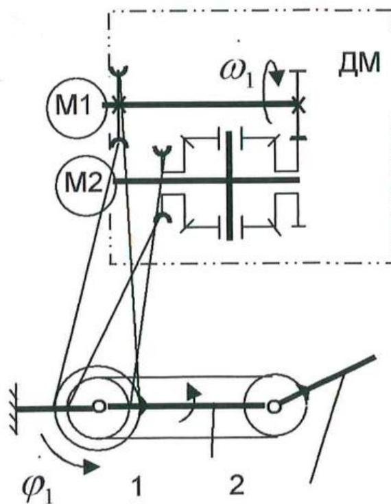
От двигателя M1 к звену 1, при функционирующем двигателе M2
