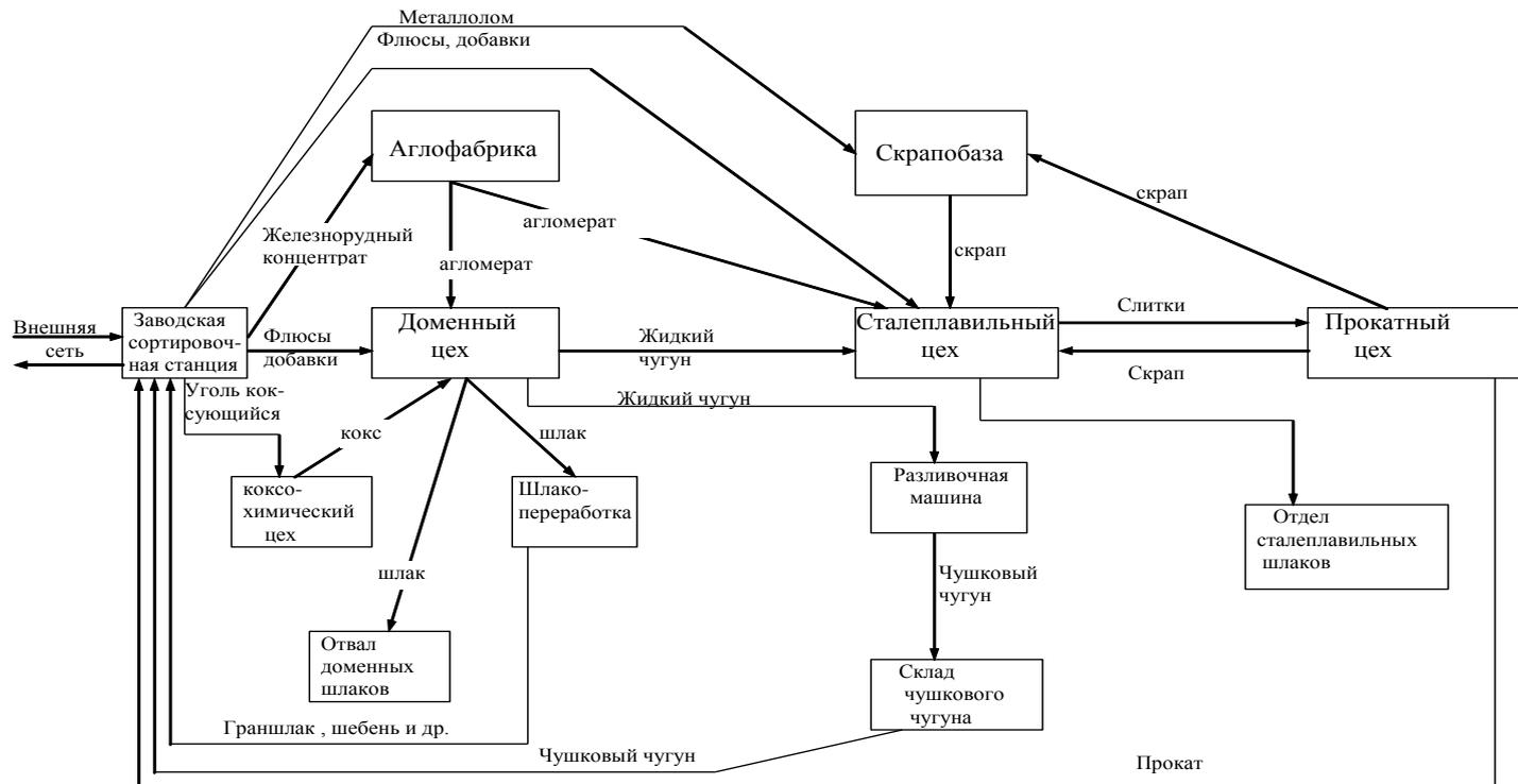
Рисунок 1.1 - Схема технологических взаимосвязей металлургического завода
