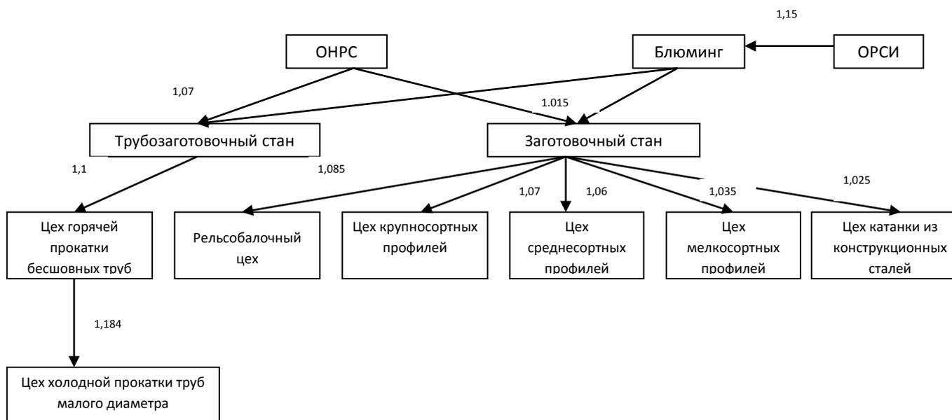
Приложение Д - Схема переработки листовой заготовки
