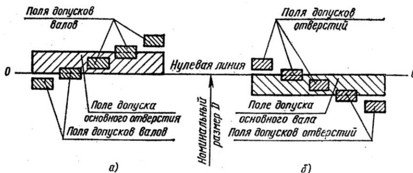
**Рис.3.** Поля допусков отверстия 1 и вала 2
