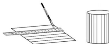
Рисунок 2. Создание криволинейных поверхностей
