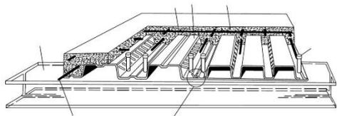
На рисунке приведена конструкция сталежелезобетонной плиты, армированная профилированным настилом. Укажите на рисунке цифру соответствующего элемента:
