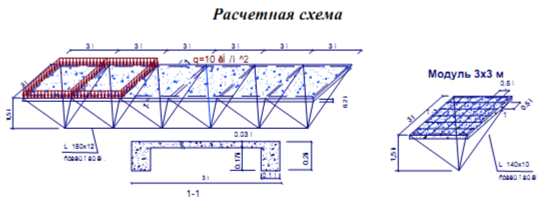
Шпренгельная плита, шарнирно опертая по торцам
