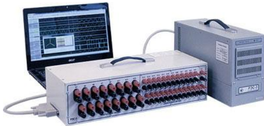
Рис. 5 Многоканальный регистратор РЭС-3 в переносном исполнении
