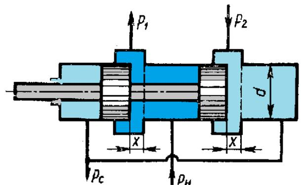
диаметры  $D = 20$  мм,  $d = 3$  мм; коэффициенты расхода дросселирующих отверстий  $\mu = 0,8$ , плотность рабочей жидкости  $\rho = 900$  кг/м<sup>3</sup>. Считать, что в пределах рабочего хода плунжера сила пружины остается-постоянной.
