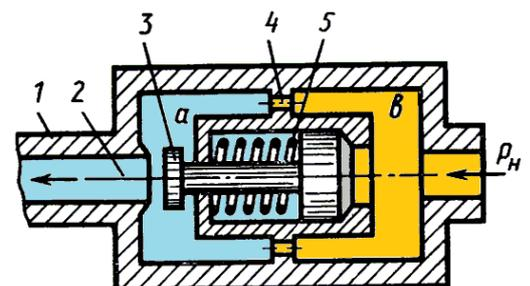
известно:  $D = 20$  мм; суммарная площадь отверстий  $4 S_0 = 0,5$  см<sup>2</sup>; коэффициент расхода отверстий  $\mu = 0,62$ ; плотность жидкости  $\rho = 900$  кг/м<sup>3</sup>.
