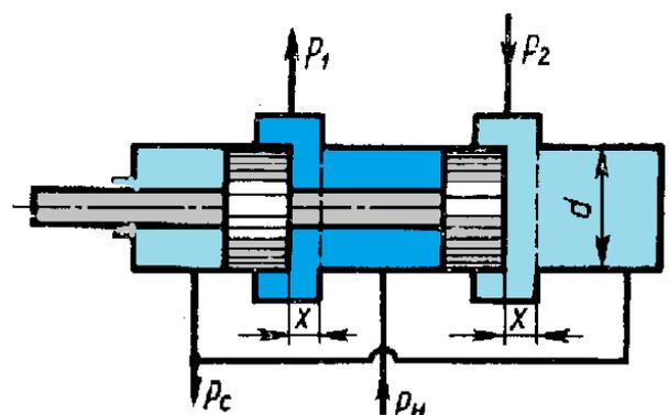
будет обеспечивать расход  $Q = 5$  л/мин, если диаметры  $D = 20$  мм,  $d = 3$  мм; коэффициенты расхода дросселирующих отверстий  $\mu = 0,8$ , плотность рабочей жидкости  $\rho = 900$  кг/м<sup>3</sup>. Считать, что в пределах рабочего хода плунжера сила пружины остается-постоянной.
