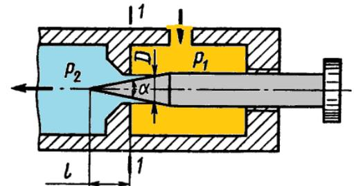
Указание. Площадь дросселирующего кольца определить по приближенной формуле  $S = S_0 - S_H$ , где  $S_0$  — площадь отверстия,  $S_H$  — площадь иглы в сечении 1—1.
