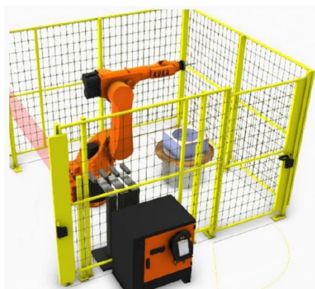
Рисунок 4 – Роботизированная инкрементальная листовая формовка
