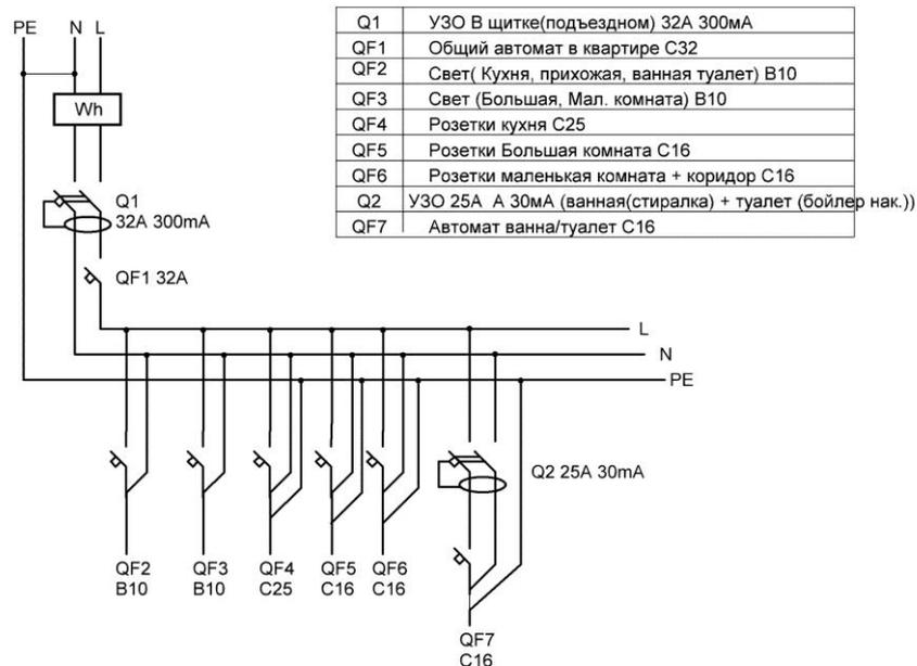
Рис.6 – Пример составленной принципиальной схемы квартирного щитка
