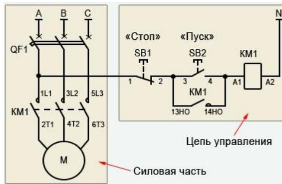
Рис.7 – Обозначения видов цепей на принципиальной схеме
