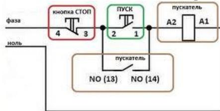
Рис.8 – Обозначение элементов на принципиальной схеме
