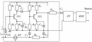
2. Поясните работу схемы задающего генератора, изображенного на рисунке. Проанализируйте поведение схемы при отказе одного из элементов (задается преподавателем)
