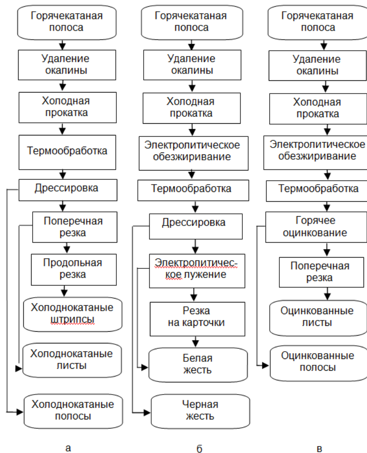
Схемы технологического процесса производства холоднокатаной листовой стали:
