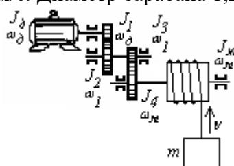
2. Данна кинематическая схема привода с вращательным движением. При вращении, например поворотной платформы экскаватора, со скоростью  $n_1 = 0,025 \text{ с}^{-1}$  статический момент на шестерне 1 равен  $M_c = 3780 \text{ Нм}$ ; к.п.д. каждой пары передачи = 0,95, а передаточные числа пар  $i_1 = 2,7$ ,  $i_2 = 2,8$ . Определить статический момент и статическую мощность на валу двигателя.
