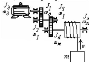
2. Дана кинематическая схема привода с вращательным движением. При вращении, например поворотной платформы экскаватора, со скоростью  $n_1 = 0,025 \text{ с}^{-1}$  статический момент на шестерне 1 равен  $M_c = 3780 \text{ Нм}$ ; к.п.д. каждой пары передачи = 0,95, а передаточные числа пар  $i_1 = 2,7$ ,  $i_2 = 2,8$ . Определить статический момент и статическую мощность на валу двигателя.
