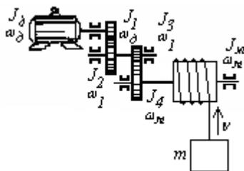
мощность, необходимую для подъема груза и скорость вращения двигателя, если масса поднимаемого груза  $m=5000\text{кг}$ , а масса крюка и блока  $m_k=300\text{кг}$ . Передаточные числа ступеней редуктора:  $i_1 = i_2 = i_3 = 4$ ; к.п.д. ступеней передачи  $\eta_1 = \eta_2 = \eta_3 = 0,92$ . Линейная скорость подъема груза  $v = 0,4\text{м/с}$ . Диаметр барабана  $1,2\text{м}$ .
