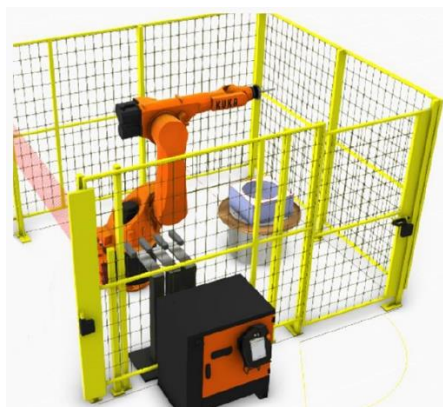
Рисунок 1 – Роботизированная инкрементальная листовая формовка
