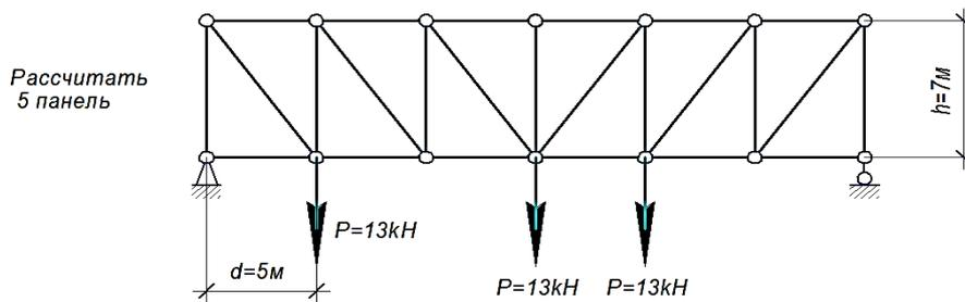
РГР №3. «Расчет статически **не**определимых систем методом сил на силовое воздействие»
