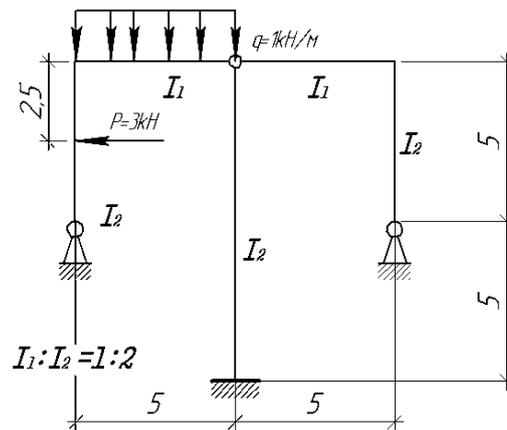
*РГР №4. «Расчет статически неопределимых систем (рамы и неразрезной балки) методом перемещений на силовое воздействие»*
