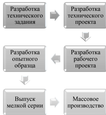
Рисунок 12. Этапы конструирования новой технической системы
