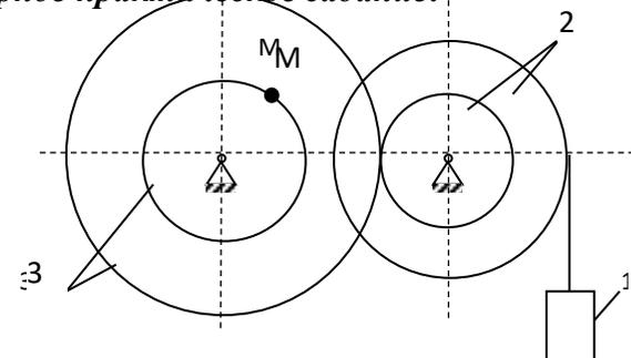
Колесо 3 с радиусами  $R_3 = 30$  см и  $r_3 = 10$  см и колесо 2 с радиусами  $R_2 = 20$  см и  $r_2 = 10$  см находятся в зацеплении. На тело 2 намотана, нить с грузом 1 на конце, который движется по закону  $s_1 = 4 + 90t^2$ , см. Определить  $v_M$ ,  $a_M$  в момент времени  $t_1 = 1$  с.
