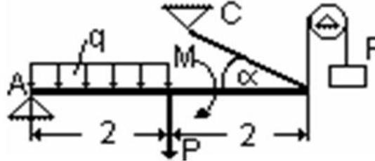
Определить реакцию опоры А и усилие в стержне ВС.
