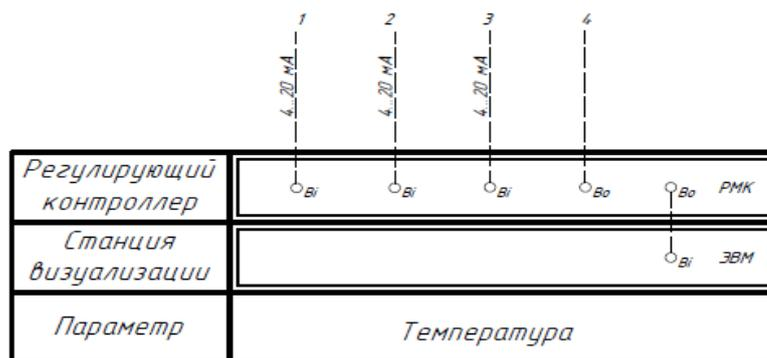
Рисунок 7 – Пример схемы автоматизации контура регулирования технологического параметра
