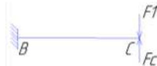
Для консольной балки можно не определять реакции опор, а непосредственно от действующей нагрузки вычислять в характерных сечениях изгибающие моменты и поперечные силы.
