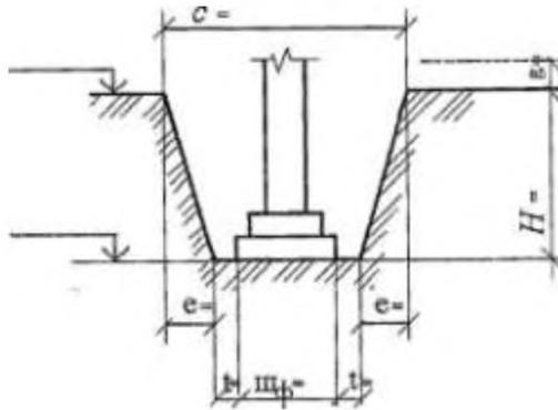
$$H = H_{\text{заложения}} - H_{\text{уровня земли}} - H_{\text{срезки}} \quad (3.6)$$
