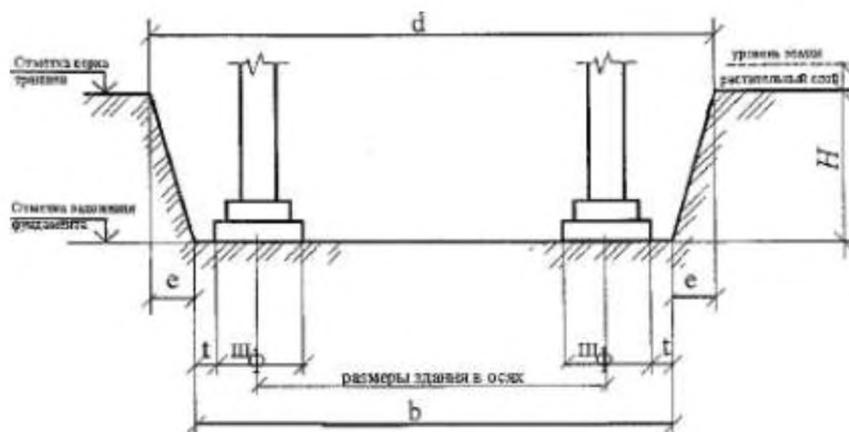
где ш<sub>ф</sub> – ширина фундамента, попавшего в разрез,
