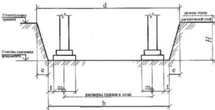
По формуле Н. Симсона определяем объём данного земляного сооружения:
