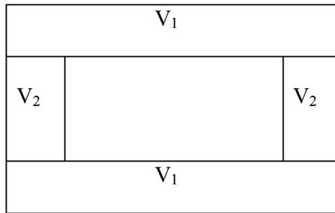
в)  $V_{\text{общ.}} = 2V_1 + V_2 + 4V_3$  – две траншеи под фундаменты крайних рядов, одна – под фундаменты среднего ряда, и четыре – под фахверковые (двухпролётное здание) (3.5)
