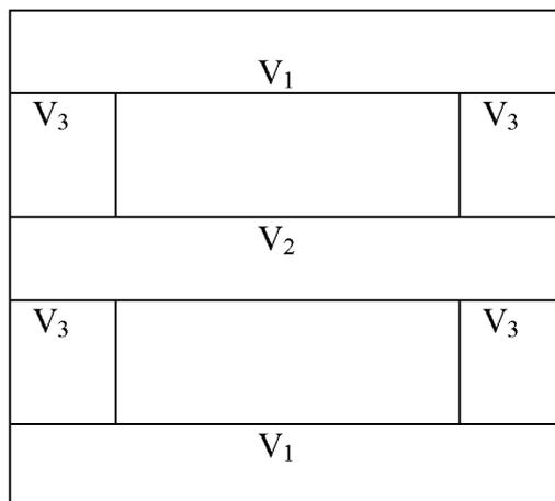
г)  $V_{\text{общ.}} = 2V_1 + V_2 + 4V_3 + 2V_3$  – для двухпролётного здания с двумя фундаментами под перегородки (3.5)
