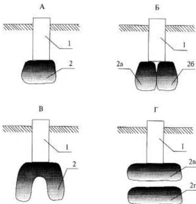
Рисунок 5.1 - Схемы устройства оснований из закрепленного грунта:
