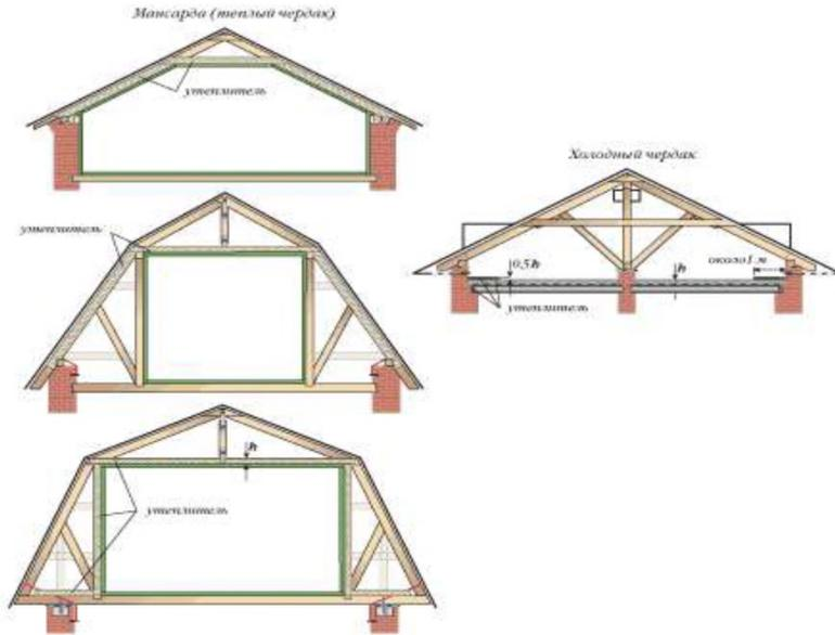
Рисунок 3.1 - Схемы расположения утеплителя в крышах различной геометрии и функционального назначения
