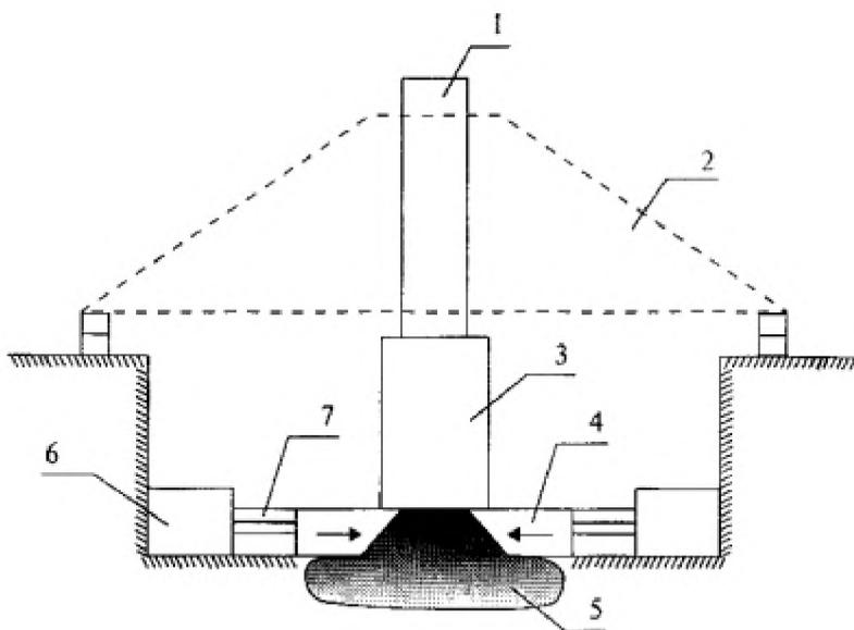
Рисунок 5.2 - Усиление фундамента с обжатием основания элементами уширения:
