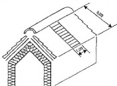
Рисунок 4.2 - К расчёту вентиляционного зазора на карнизном свесе.
