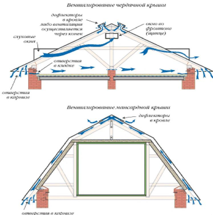
Рисунок 4 1 - Устройство вентиляции подкровельного пространства .
