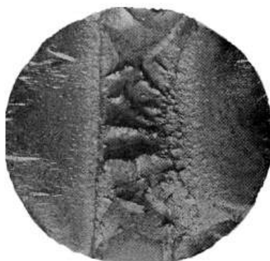
Рис. 1.6. Усталостный излом штока компрессора
