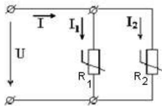
Рисунок 4 – Параллельное соединение нелинейных элементов
