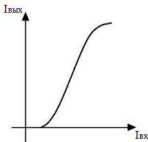
**Передаточные параметры** в зависимости от типа оптрона определяются коэффициентом передачи по току  $I_{\text{ВЫХ}}/I_{\text{ВХ}}$ , для диодных и транзисторных оптронов ( $K_i$  - диодных  $0,2 \div 0,005$ , у транзисторных - до 1).
