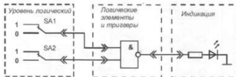
Рисунок 13 - Схема соединений для исследования логического элемента И-НЕ
