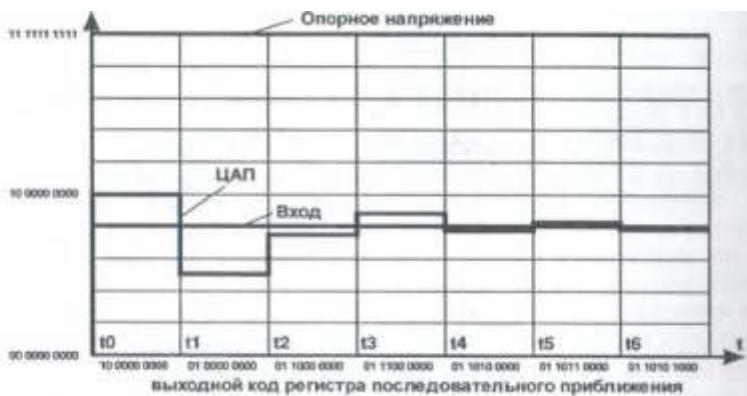
Рис. 2. Принцип работы АЦП последовательного приближения
