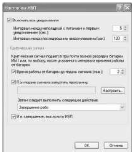
Рис. 14. Настройка интерфейса ИБП
