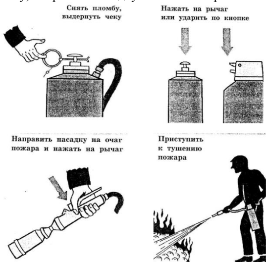
Рис.1. Приведение в действие воздушно-пенного огнетушителя.
