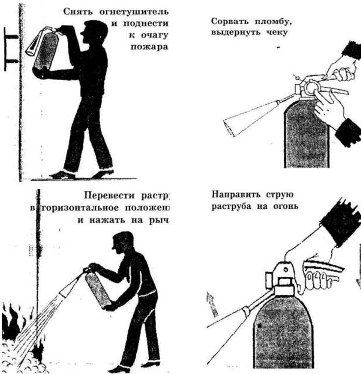
Рис. 3. Приведение в действие ручного углекислого огнетушителя.
