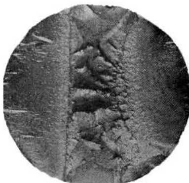
Рис. 1.6. Усталостный излом штока компрессора
