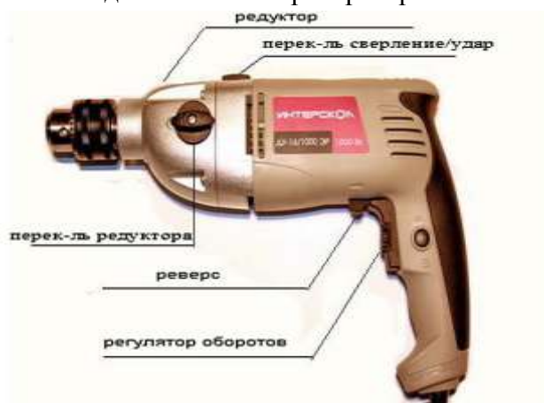
Рисунок 1 - Схема устройства электродрели.
