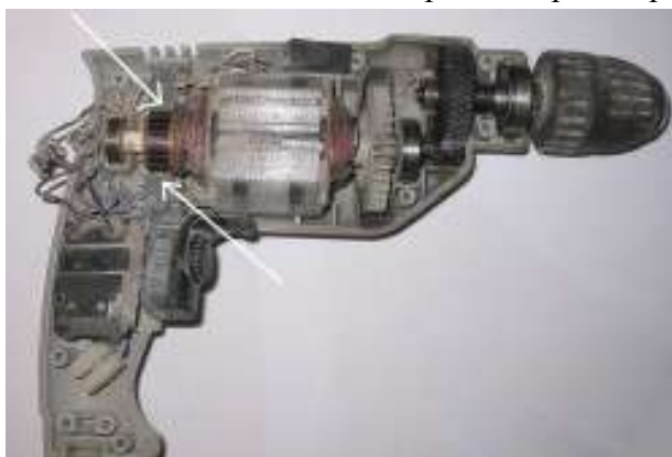
Рисунок 2 - Расположение контактных щеток внутри дрели.
