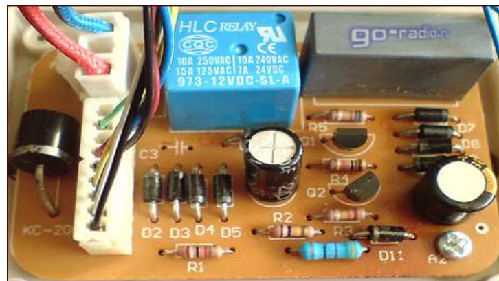
Рис. 4 Основная электронная плата термopота
