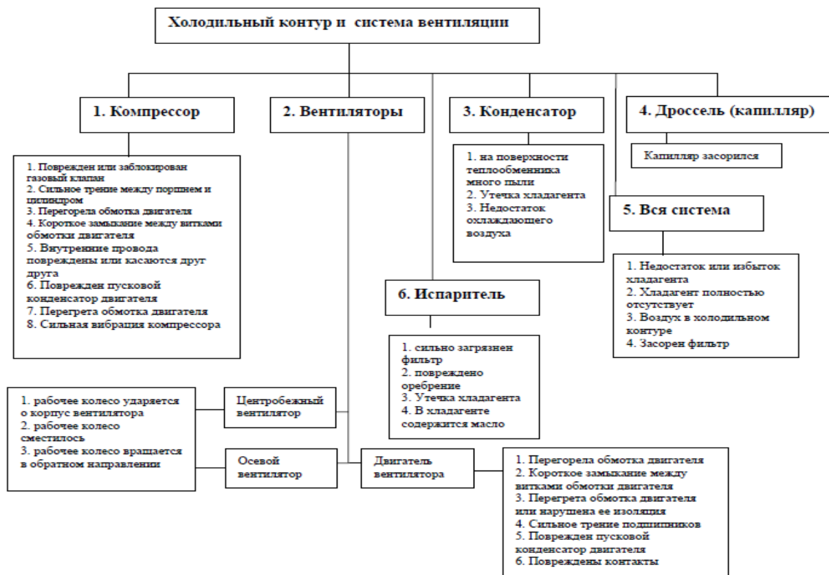
Схема общего анализа неисправностей кондиционера
