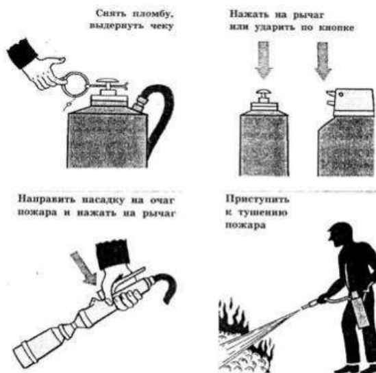
Рис.1. Приведение в действие воздушно-пенного огнетушителя.
